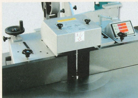
Fräsanschlag mit digitaler Positionsanzeige T2027 / T2627
