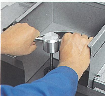
Schnellwechsel des Fräsdorns mit dem Drehmomentschlüssel
