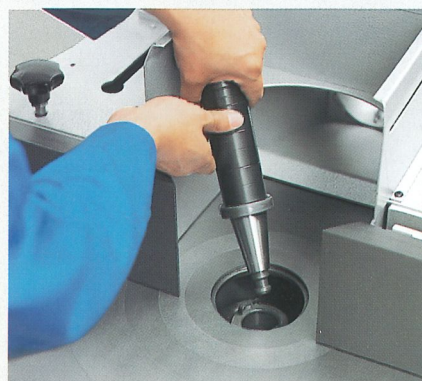
Präzise – Fräsdorn mit Steilkegel-Aufnahme SK 40
