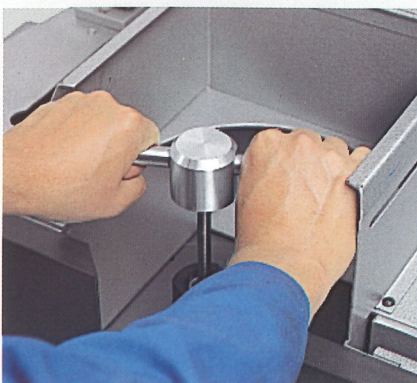
Changement rapide du mandrin par la clé dynamométrique
