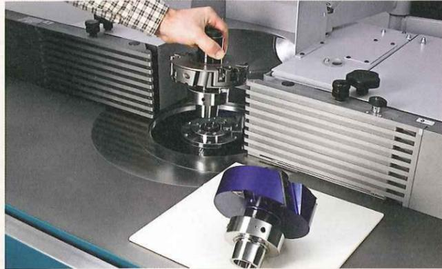
Sistema de cambio rápido mandril portafresa HSK
