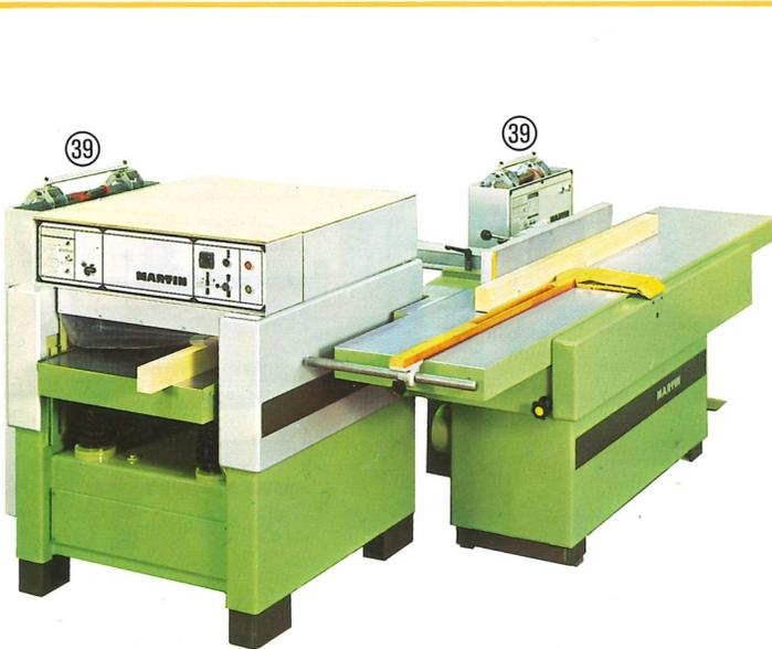
Dickenhobelmaschine T 43 und Abrichthobelmaschine T 52 in platzsparender Anordnung mit bestem Arbeitsablauf. (Schutzbügel T 438 erforderlich).
