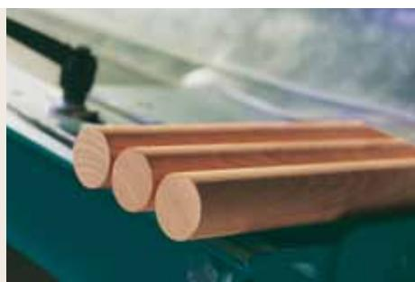
Готовые цилиндрические детали за два прохода
