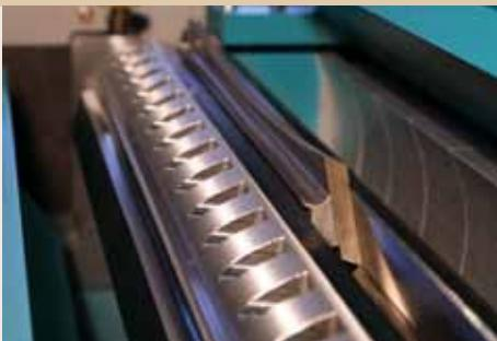
Цельнометаллический „Строгально-Калевочный“ ножевой вал с двумя ножами TERSA и четырьмя с зубчатым креплением для профилирующих ножей T4505/4-a
