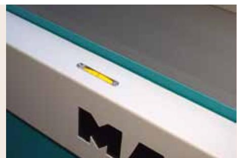
Хорошо считываемая шкала для снятия стружки
