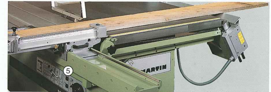
Kreissägeleinal unter Tisch abgeklappt
