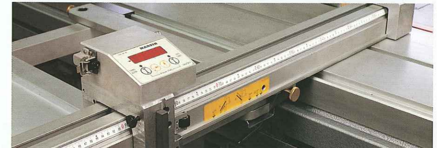
Längenschnitz vorne am Quertisch aufgesetzt
