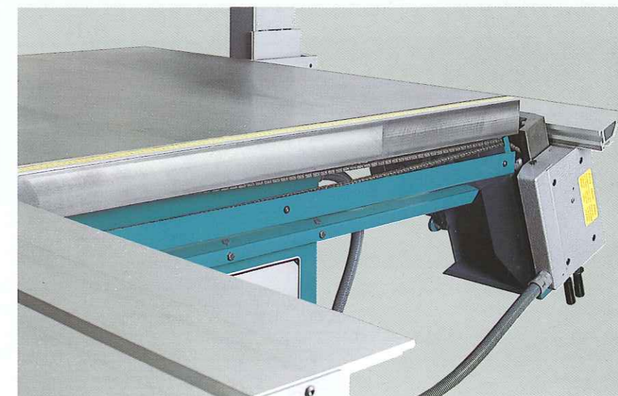
Linealen klappet ned under maskinbordet.
