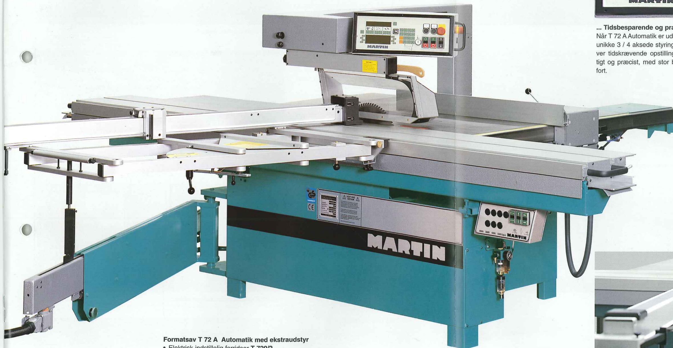
Den 4. akse på parallelogrambordet: Styrede gearhingsnit
