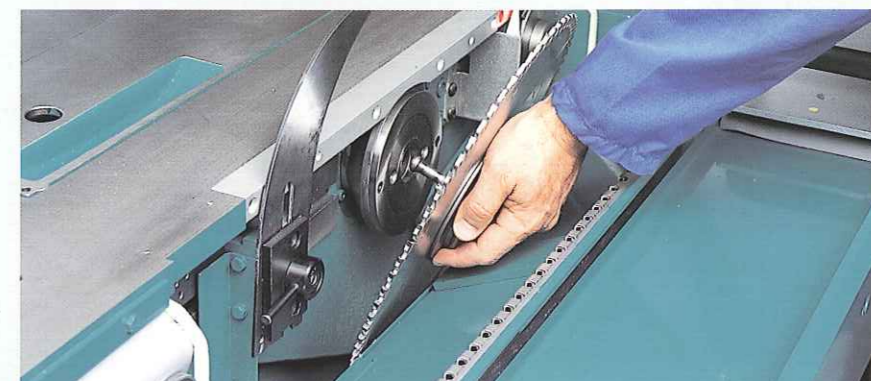
T 7241 hurtigvekselsystem til hovedsavklingen
