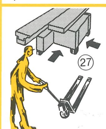
Maschine allseitig mit Stapler oder Hubwagen unterfahrbar. Leichte Reinigung vom Ständer-Innenraum.
