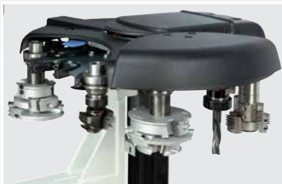
Magazzino utensili circolare a 16 posizioni per cambio utensile automatico. Attacco cono HSK-F63.
