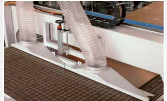
Dispositivo di auxilio allo scarico, regolabile manualmente in altezza, per l'espulsione dei particolari lavorati dal piano macchina pulizia dello stesso.
