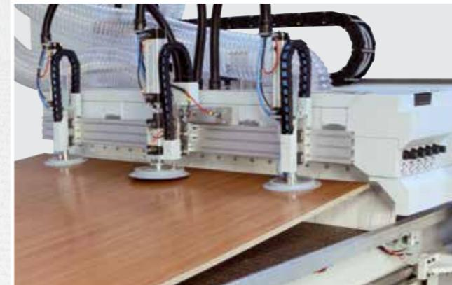
Dispositivo di presa ed accostamento pannelli per prelevare il pannello dalla piattaforma elevatrice ed accostarlo ad una guida di riferimento.
