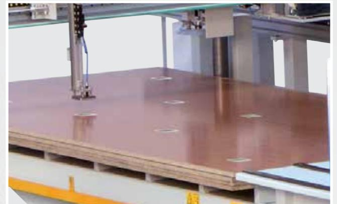
Il dispositivo di etichettatura provvede alla stampa di etichette e al loro posizionamento automatico sul pannello posto sulla piattaforma di carico.
