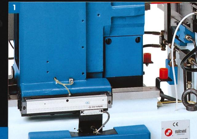
**I** L'unità a microprocessore gestisce lo spostamento della testa di bedanatura per il controllo della profondità di lavorazione con l'impiego di una riga optoelettronica. (OM B1 ES 2 - OM B1 ES 2B).
