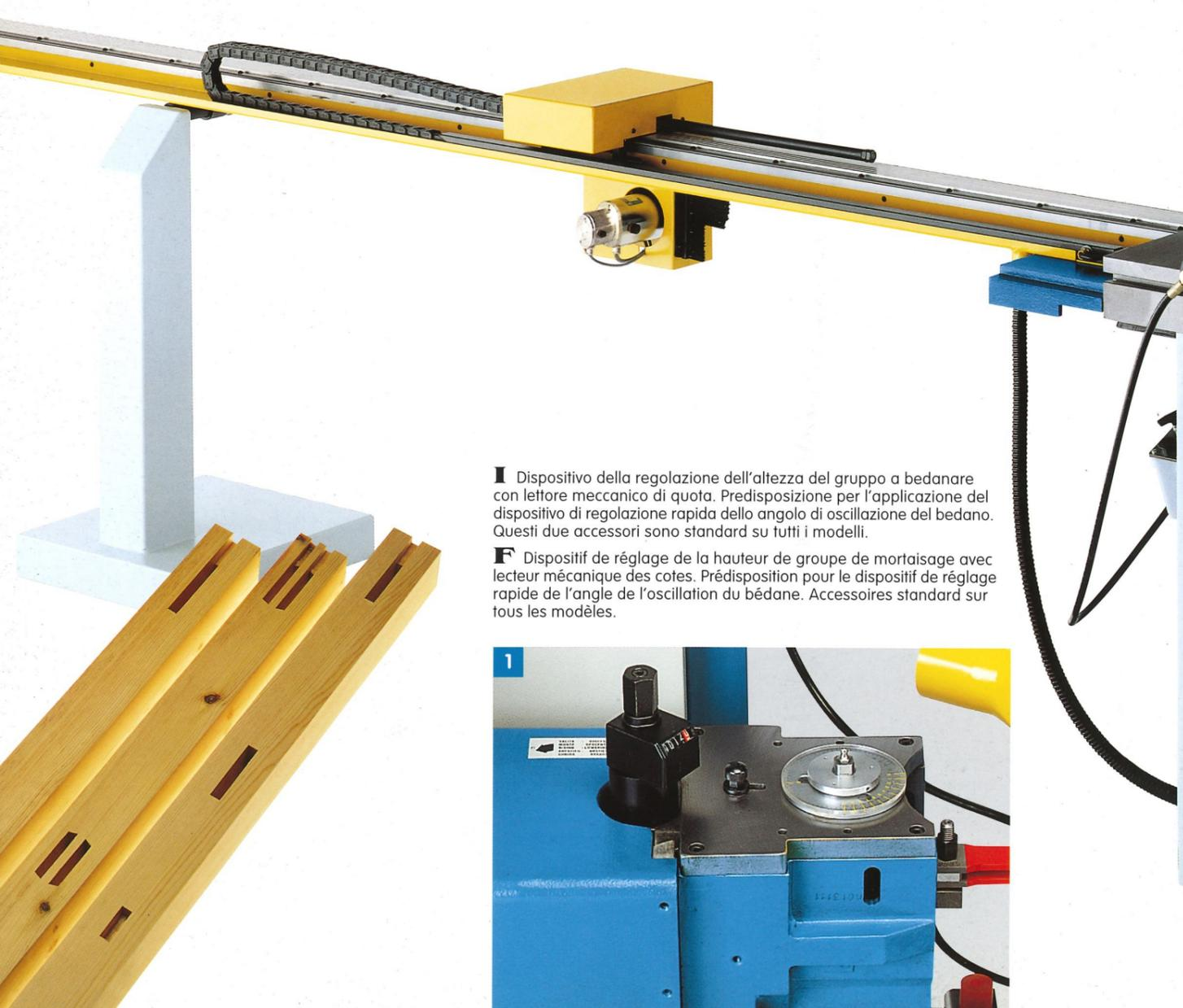
**I** Dispositivo della regolazione dell'altezza del gruppo a bedanare con lettore meccanico di quota. Predisposizione per l'applicazione del dispositivo di regolazione rapida dello angolo di oscillazione del bedano. Questi due accessori sono standard su tutti i modelli.
