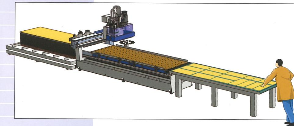
Sistema di carico e scarico automatico con piattaforma elevatrice idraulica e tappeto motorizzato.
