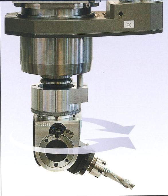
Rotazione asse C per l'impiego di testine angolari fisse o inclinabili.
