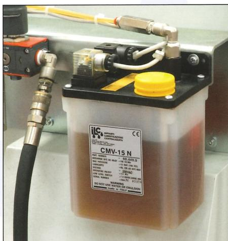
Lubrificazione automatica centralizzata gestita da CN su tutti i movimenti della macchina.
