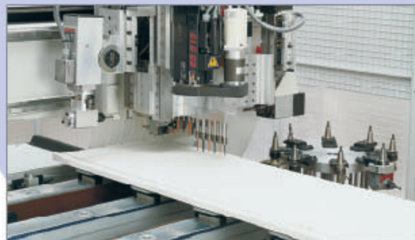
Gruppo di foratura per fori orizzontali su 4 lati e fori verticali con mandrini indipendenti. Groupe pour perçages horizontaux sur les 4 côtés et perçages verticaux avec mandrins indépendants. Bohraggregate für Horizontalbohrungen auf 4 Seiten und Vertikalbohrungen mit einzeln abrufbaren Vertikalspindeln.
