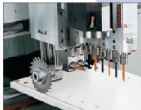
Gruppi lama per incisioni e tagli. Groupe scie pour incisions et coupes. Sägeaggregate für Nuten und Schnitte.
