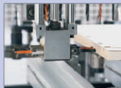
Gruppo di foratura per fori orizzontali su 4 lati e fori verticali con mandrini indipendenti. Groupe pour perçages horizontaux sur les 4 côtés et perçages verticaux avec mandrins indépendants. Bohraggregate für Horizontalbohrungen auf 4 Seiten und Vertikalbohrungen mit einzeln abrufbaren Vertikalspindeln.
