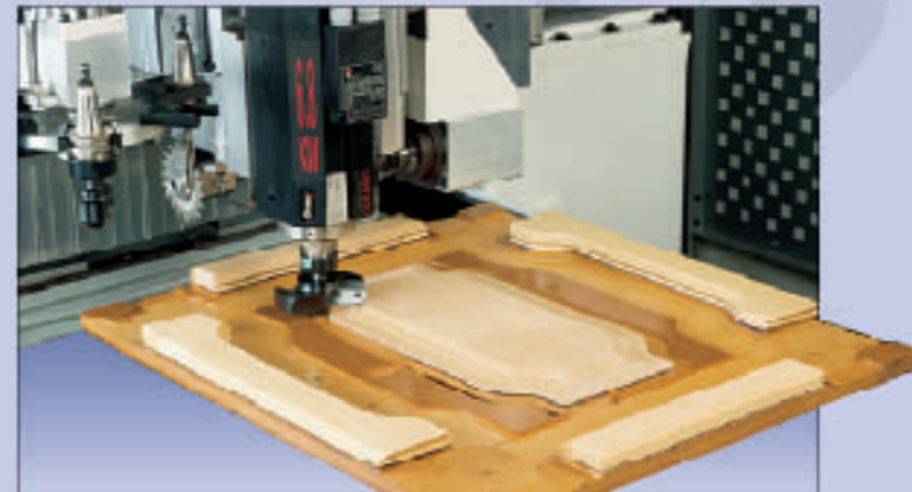
Preparazione dima e lavorazione pezzo. Preparation gabarits y usinage pièce. Schablonenvorbereitung und Werkstückbearbeitung.
