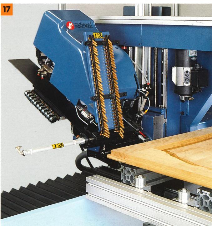
**17** Gruppo di anubatura con punta di foratura, mandrino di avvitatura e caricatore a doppio magazzino per anuba maschio e femmina e 4 assi controllati gestiti dal controllo numerico.
