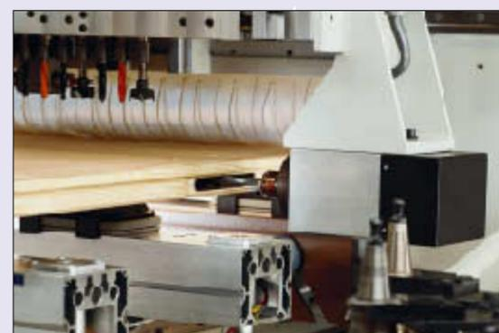
Lavorazione sede serratura con fresatore diretto.
