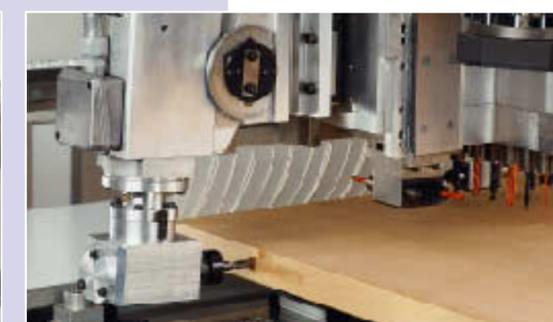
Lavorazione sedi per pomelle con fresatore inclinabile.
