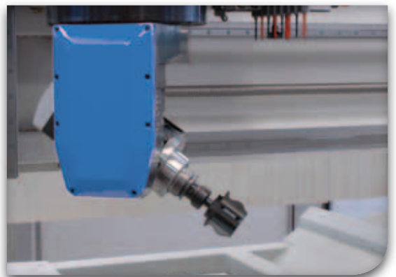
Elettromandrino con raffreddamento a liquido Electromandrin à refroidissement liquide Elektrospindeln mit Flüssigkeitsumlaufkühlung
