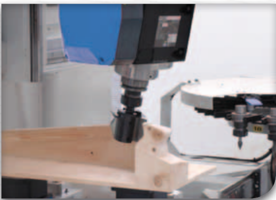
Elettromandrino con raffreddamento a liquido Electromandrin à refroidissement liquide Elektrospindeln mit Flüssigkeitsumlaufkühlung
