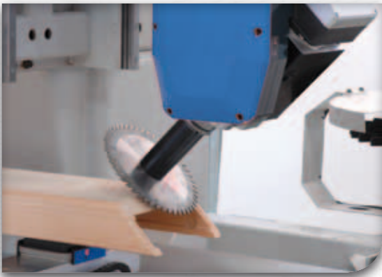
Gruppo fresatore birotativo per lavorazioni a 5 assi Groupe de fraisage birotatif pour les usinages à 5 axes Doppelt rotierender Fräsmotor für 5-Achs-Bearbeitungen
