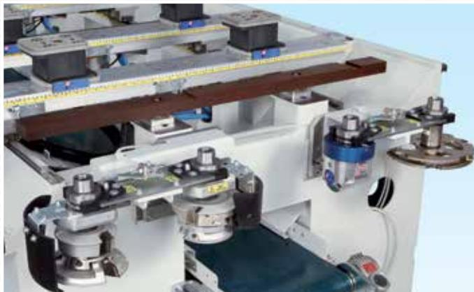
Магазин для автоматической смены инструмента расположен на каретке; магазин под инструмент больших размеров расположен справа на станине станка.
