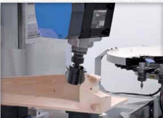
Электрошпиндель с жидкостным охлаждением
