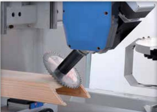
Фрезерный узел с взаимопротивоположными направлениями вращения для 5-осной обработки
