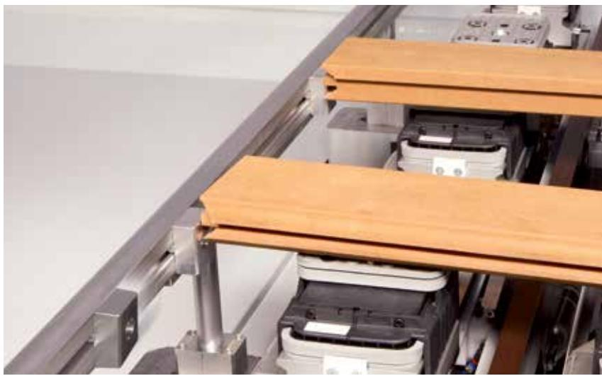
Le battuta laterali scorrevoli permettono di posizionare più pezzi in modo preciso e senza sprechi di tempo.
