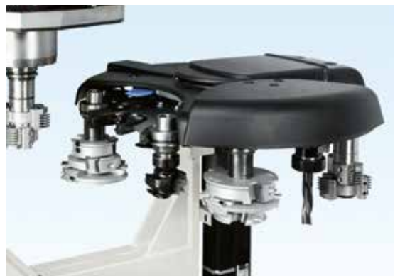
Vloeistofgekoelde freesmotor, boorunit, zaagunit en grote gereedschapwisselaars voor maximale flexibiliteit.
