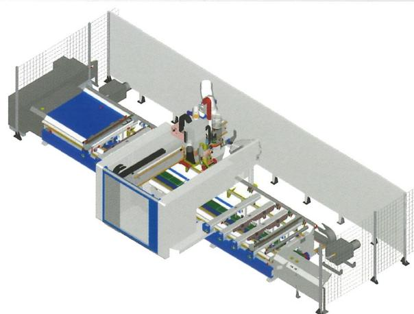
Nella versione "CE" è disponibile anche il sistema di protezione con "bumpers". Ciò permette, limitando la velocità massima sull'asse x a 40 m/min, di ridurre l'ingombro in pianta della macchina.
