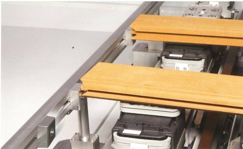
Le battuta laterali scorrevoli permettono di posizionare più pezzi in modo preciso e senza sprechi di tempo.
