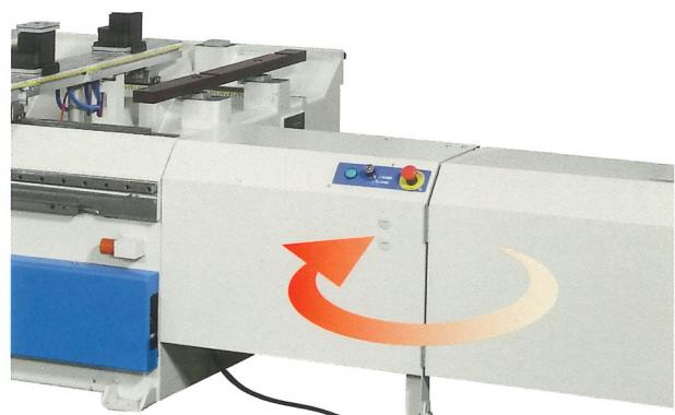
Lubrificazione automatica centralizzata gestita da CN su tutti i movimenti della macchina.
