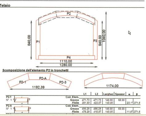
Masterwindow ermöglicht die Fertigung von Fenstern in Standard- und Sonderausführung, wobei von parametrisch vorgegebenen Modellen ausgegangen wird. Die Bedienung von Masterwindow ist äußerst einfach: der Bediener erhält Schritt für Schritt Anweisungen über die Vorgangsweise, von der Auswahl der Form bis zur Zerlegung der verschiedenen Fenstersegmente.
