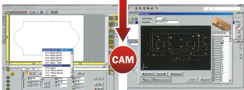
Programmazione grafica di foratura, fresatura, taglio e ottimizzazione del ciclo di foratura.
