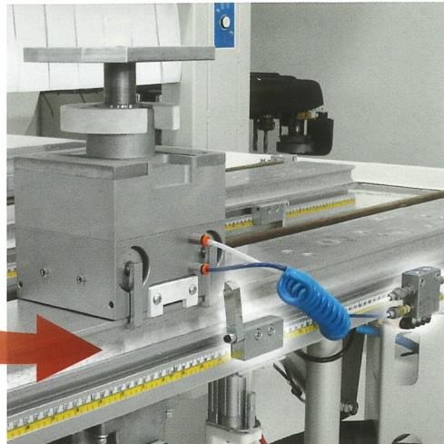
Dispositivi meccanici di bloccaggio per la lavorazione di elementi in massello, lineari e ad arco.
