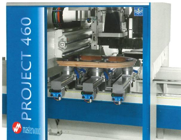
Cuffia di aspirazione con altezza variabile (std) e deflettore di trucioli sull'utensile (opt) gestiti da CN per l'ottimizzazione dell'aspirazione.
