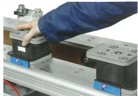
Il sistema di depressione permette il posizionamento rapido dei dispositivi di bloccaggio riducendo notevolmente i tempi per la configurazione del piano di lavoro.
