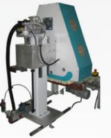
RB300 Aggregat mit motorischer Höhenverstellung und Oszillationseinheit
