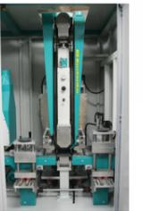
Kalibrier- und Feinschleifaggregat BA300
