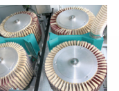
Große Bürstendurchmesser optimieren die Oberflächenqualität. Vakuumtransportsystem ermöglicht auch kurze Teile.
