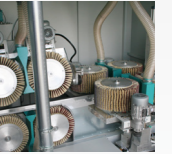
Vollautomatisches und allseitiges Schleifen aller Fenstertypen IV 70 bis 105 und Holz-Alusysteme.
