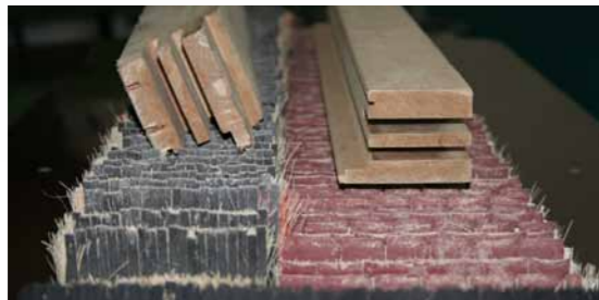
Zwei Schleifbereiche 100 mm und 150 mm mit unterschiedlicher Schleifmittelbestückung
