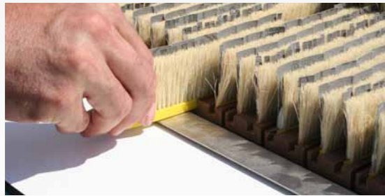
Leicht austauschbare Schleifbürstensegmente
