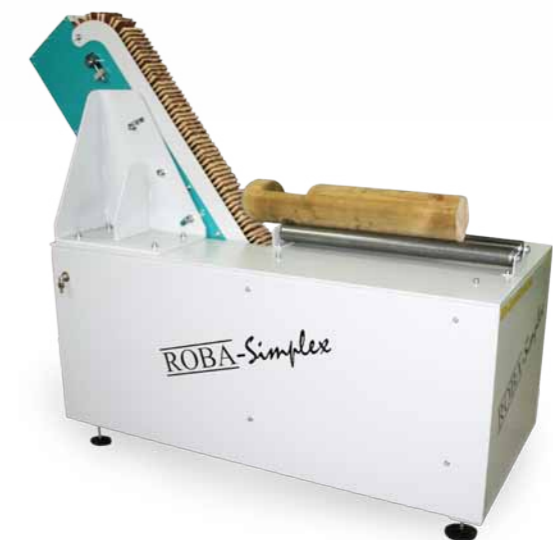
Sonderkonstruktion zur Bearbeitung von Rundhölzern
