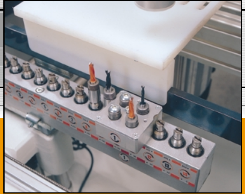
▲ Bohraggregate. Die Nummer der Aggregate kann nach Bearbeitungsbedarf aendern.
