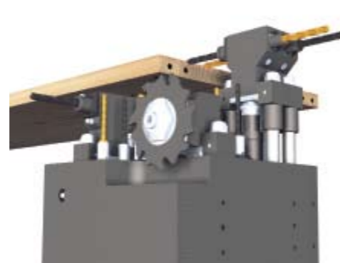
Esecuzione fori in testa (asse X) Top horizontal boring (X axis)
