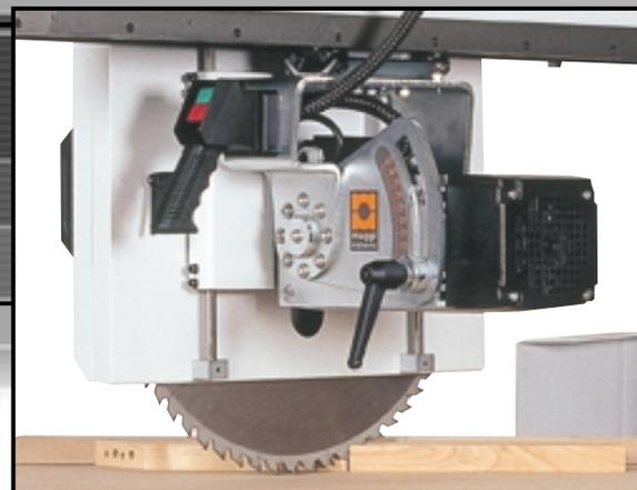
▲ Carter copilama insonorizzato regolabile che garantisce una copertura completa della lama per ogni profondità di taglio. Predisposto per una facile sostituzione della lama.
