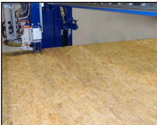
Ein beweglicher Werkzeugschlitten kann mit bis zu drei Werkzeugen gleichzeitig ausgerüstet werden – z.B. für das Klammern der Verkleidung und die Nagelbefestigungen für die Lattung. Optional kann ein zweiter Werkzeugaufnehmer montiert werden, so dass gleichzeitig der untere und obere Riegel vernagelt werden können.
