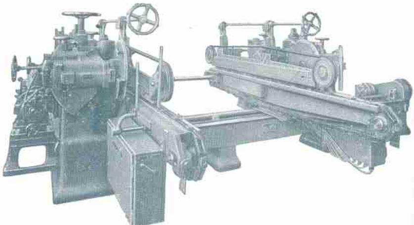
Doppelte Zapfenschneid- und Schlitzmaschine
