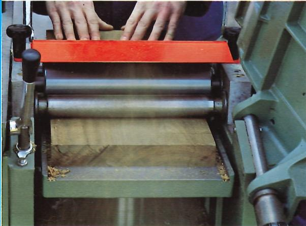
**DICKENHOBEL:** Der Dickentisch ruht auf einer schweren zentralen Säule. Autom. Vorschub des Werkstückes mit Rückschlagsicherungen.
