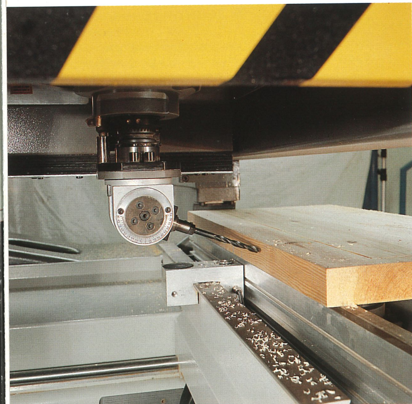
Horizontal und vertikal verstellbarer Winckelgetriebe mit Aufnahme für Bohrer und Nutsäge.
