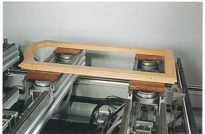
▲ Der Einsatz von Spezialvorrichtungen gewährleistet auch die Fixierung von Werkstücken mit außergewöhnlichen Abmessungen
