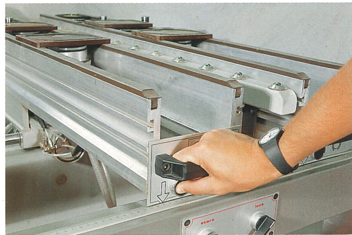
▲ Leicht verstellbare Werkstückauflagen mit pneumatischem Löse- und Arretiersystem
