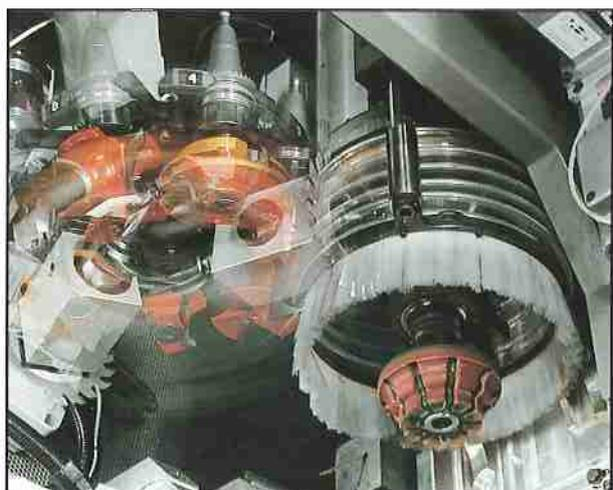
Der automatische Werkzeugwechsler ist während anderer Bearbeitung, ohne Zeiverlust möglich.
