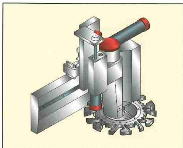
Die Vorrichtung ermöglicht immer den freien Zugang zu allen Maschinenfeldern, eventuelle Vorgänge zum Werkzeugwechsel haben hierauf keinen Einfluß, somit wird dem Bediener absolute Sicherheit gewährleistet und auch eine größere Produktivität erzielt.
