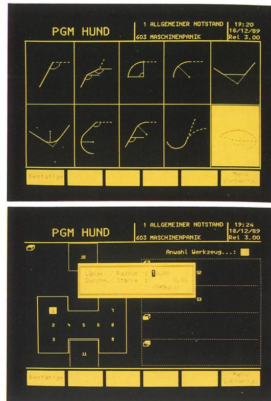
L'interfaccia operatore-macchina avviene attraverso un monitor grafico da 8" ad alta risoluzione che permette all'operatore di avere all'istante attraverso aiuti grafici e sintattici, tutte le informazioni necessarie per la programmazione e per il controllo dei cicli di lavorazione.
