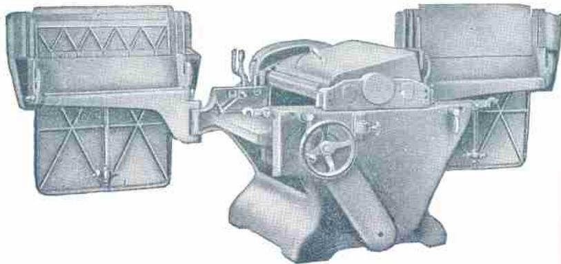
**Kombinierte Abricht- und Dickenhobelmaschine**
