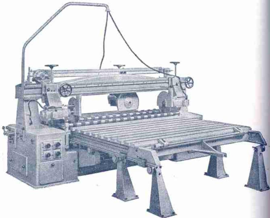
**Sperrholz- und Formatkreissäge, hydraulisch**
