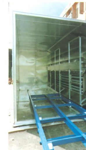
Querbelüftete Trockenkammer für 2 Stapelpakete, wagenbeschickt, Flügeltür stirnseitig, Elektro- und Warmwasserheizung, automatisch umschaltbar, Stapellänge beliebig, Bruttostapelinhalt 10 bis ca. 100 m 3 , Lieferung steckerfertig.
