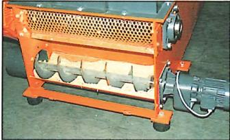
Zubehör: Bei schwächeren Absaugungen kann das Schnittgut mit einer Schnecke direkt dem Ventilator kontinuierlich zugeführt werden (Mehrpreis).
