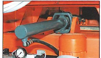
Hydraulikzylinder »kardanisch« aufgehängt, um Querkräfte auf die Kolbenmanschetten zu vermeiden.
