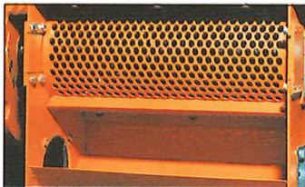
Unterhalb des Rotors ist das Lochsieb angebracht. Großer Umschlingungswinkel – dadurch pro Umdrehung hoher Spanauswurf. Schnittzellgröße je nach Lochsiebdurchmesser.
