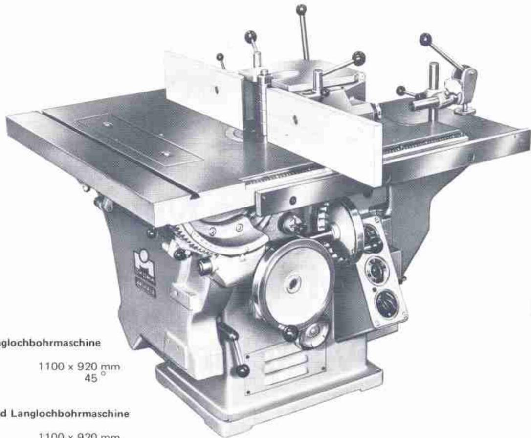
**Kombinierte Kreissäge- und Langlochbohrmaschine**
