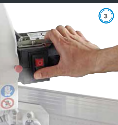
Mando rotación cabezal junto a la empuñadura (rotación rápida).
