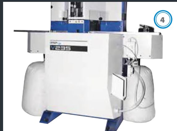
Kit 2 aspiratori Aspiratori singoli su ogni bocca: Ø 80 mm Velocità d'aspirazione: 20 m/sec Portata per ogni bocca: 320 m3/h Per V235 e V235FNC
