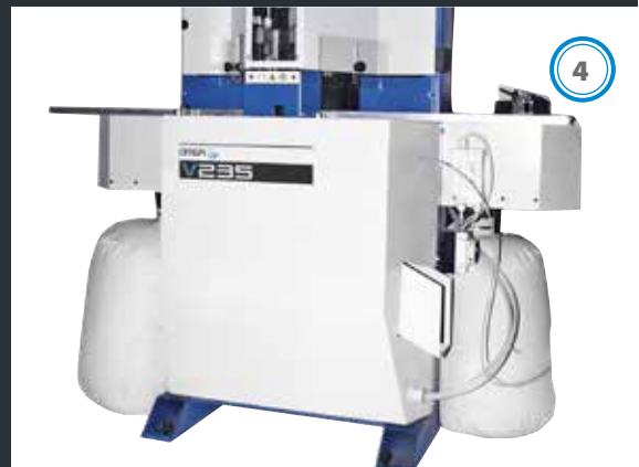
Juego de dos unidades de aspiración. Aspiradores síngulos sobre cada boca: Ø 80 mm Velocidad de aspiración: 20 m/sec Capacidad por hora, cada boca: 320 m3/h (V235 - V235 FNC)
