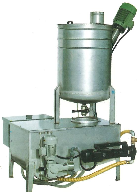
▲ Gruppo con doppio serbatoio colla (serbatoio di preparazione e serbatoio di servizio) consente la preparazione dello sciroppo collante senza interrompere l'alimentazione dell'incollatrice.
