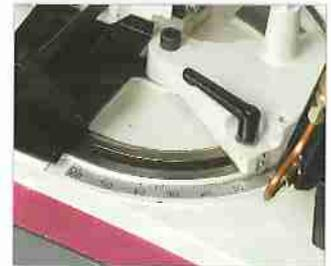
■ Beidseitig schwenkbar von  $-45^\circ$  bis  $+60^\circ$
