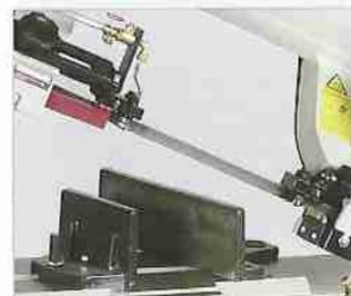
■ Verstellbare Spannbacken des Schnellspannschraubstocks von 0° bis 45° für Gehrungsschnitte
