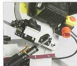
■ Mit hydraulischem Gegendruckzylinder für selbsttätige stufenlos einstellbare Absenkgeschwindigkeit
