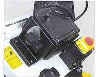
■ Drei Sägebandgeschwindigkeiten 39/66/82 m/min. über Getriebe schaltbar
