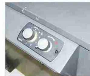
■ Einfache Einstellung der Absenkgeschwindigkeit im Bedienfeld
