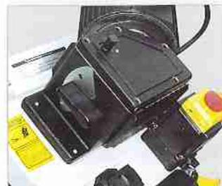
■ Drei Sägebandgeschwindigkeiten 39/66/82 m/min. über Getriebe schaltbar
