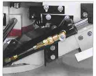
■ Mit hydraulischem Gegendruckzylinder für selbsttätige, stufenlos einstellbare Absenkgeschwindigkeit
