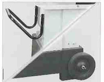
■ Große Räder und handlicher Transportbügel ermöglichen problemlosen Standortwechsel der Metallbandsäge
