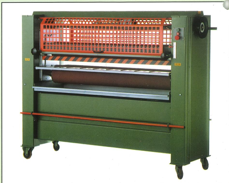
**2-WALZEN LEIMAUFTRAGSMASCHINE TYP I/213.** Ist aus langjæhriger Erfahrung entstanden, womit sie heute mit optimalen technischen Eigenschaften, grosser Leistungsfæhigkeit und voelliger Sicherheit zu den besten Maschinen im Holzbereich zaehlt. Sorgfaeltige und gleichmaessige Leimauftragung mit verschiedenen Leimarten ist moeglich. Sehr geeignet fuer Presstrassen.
