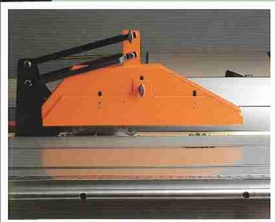
Parallelogrammschutzhaube über dem Spaltkeil.
