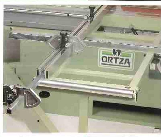
Doppelanschlüge der einstellbaren Querskala mit regulierbarer Lupe und gut lesbaren Präzisionsskalen.
