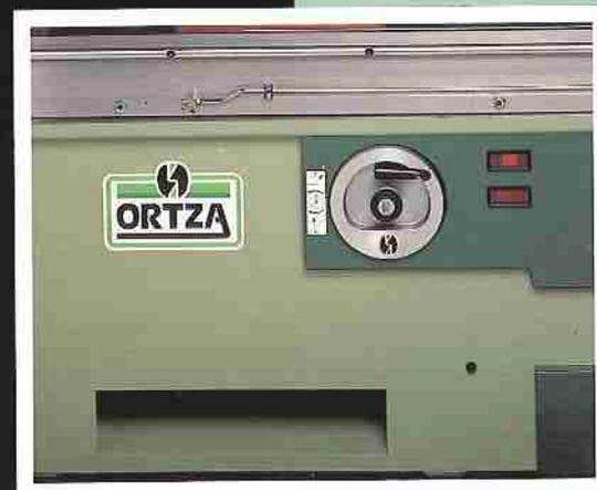
Frontansicht der Maschine mit Schwenkrad und Digitalanzeige des Neigungswinkels des Sägeblatts und sowie Reinigungsfenster.
