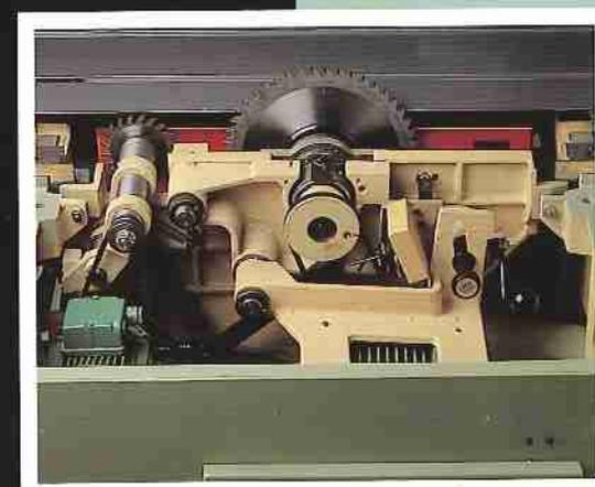
Teilansicht des inneren Aufbaus der wartungsfreien, robusten Baugruppe Hauptwelle und des Vorritzaggregats.
