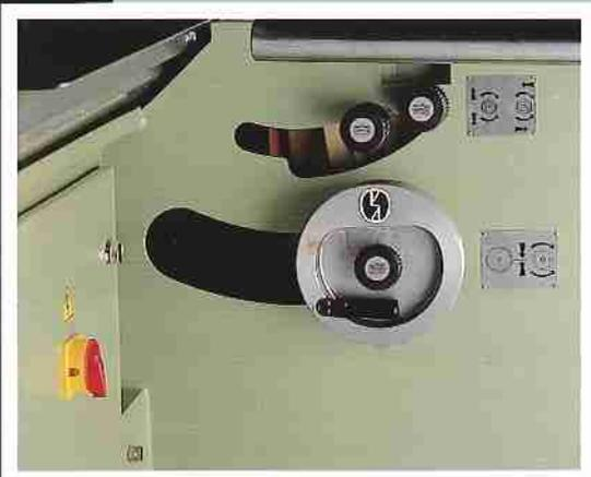
Schaltschrank mit Öffnungssperre bei Netzanschluss, Abschließbarer Hauptschalter.
