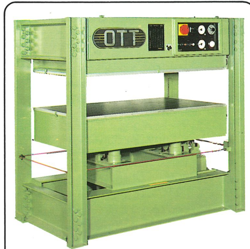
Zerlegbare Ausführung, wenn die Türöffnungen zu klein sind oder es sonstige Aufstellungsprobleme gibt.
