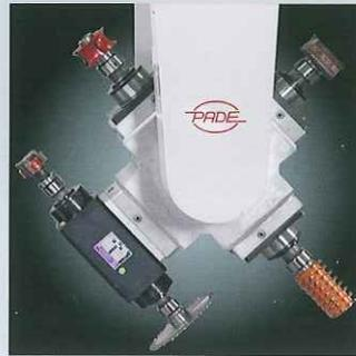
» Testa composta da 4 motori - di cui 3 in linea - ed 1 motore orizzontale a due uscite. I principali vantaggi di questa soluzione sono: 5 mandrini a disposizione; possibilità di lavorazioni a "filo" bancale; lavorazioni in spazi particolarmente ristretti; lavorazioni di pezzi con M4.
