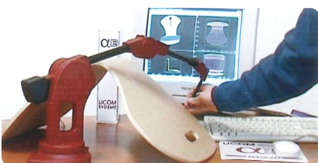
**L**as operaciones de fresado complejas son programadas por medio de CAD/CAM, que por solito es interactuada con el digitalizador tridimensional para poder detectar las formas directamente del modelo.
