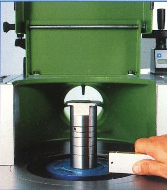
■ Zeromaster Referenz-mass-Einstellgerät zur Nullung eines neu eingesetzten Werkzeugs.
