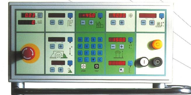
**Das Bediendisplay im schwenk- und ausziehbaren Schaltpult oben.**
