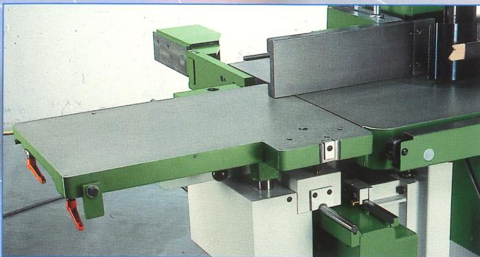
■ Rolltisch als Tischverlängerung links eingesetzt. Konsole zum Wegschwenken eines Vorschubapparates.
