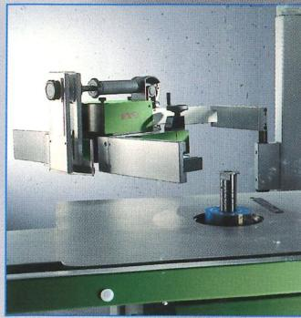
■ Wegschwenkvorrichtung durch elektromotorisches Heben und Senken des Fräsanschlags.
