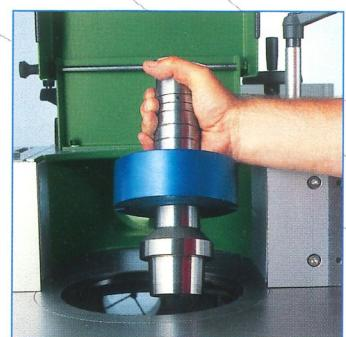
**Système d'échange rapide de l'arbre HSK-80 avec diamètre de l'arbre de 30 mm, hauteur de serrage 140 mm en exécution standard. Changement de l'arbre dans moins de 30 secondes.**
