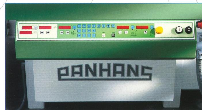
**Bediendisplay an ausziehbarer Rahmenauflage.** 2-Achsen-Positioniersteuerung für Höhen und Schwenkverstellung. Automatische Kalibrierung der Schwenkanzeige. Digitale LED-Anzeigen für axiale Spindelposition (Absolutanzeige), vertikalen Spindelverfahrtweg (Inkrementalanzeige), Gradanzeige für Schwenkverstellung, Spindeldrehzahl. Betriebsstundenzähler für Dauer- und Projektanzeige ist Sonderzubehör.
