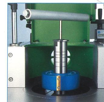
**Fräsdorn Schnellwechselsystem HSK-80 mit Spindeldurchmesser 30 mm, Einspannhöhe 140 mm in Standardausführung. Fräsdornwechsel in weniger als 30 sek. Keine Pneumatik notwendig.**
