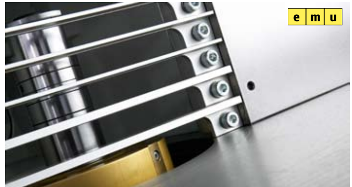
Sicherheitslineale, durchgehende Führung beim Fräsen am Anschlag
