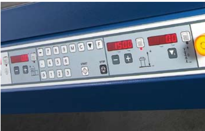
2-Achs-Positionssteuerung zur Höhen- und Schwenkverstellung
