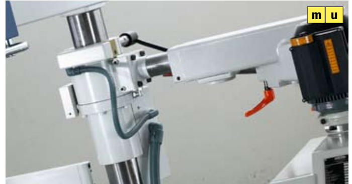
Comfort-Vorschub-Tragarm, elektromotorisch höhenverstellbar, Positionierung über Achsenmodul
