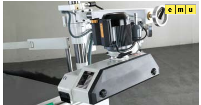
Vorschubapparat PV 84, 4 Rollen, 8 Geschwindigkeiten
