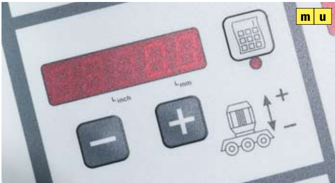
Steuerungs-Bedienfeld für Comfort-Vorschub-Tragarm
