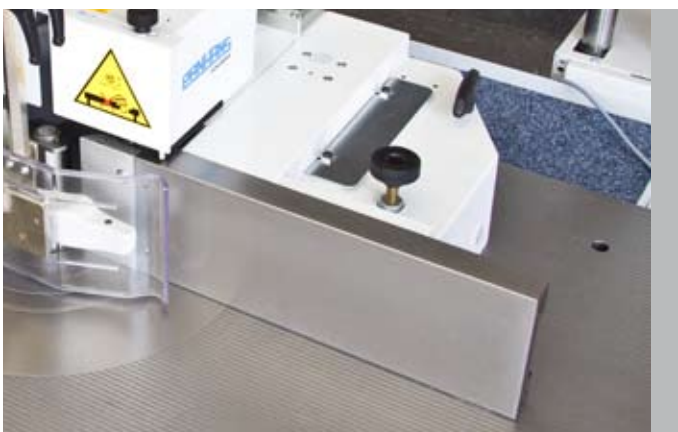
Komfortklemmeinrichtung für Anschlagbacken
