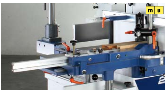
Rolltisch zur sicheren und rückschlagfreien stirnseitigen Bearbeitung Ausführung: e = easy, m = medio, u = ultimo = Serie = Option
