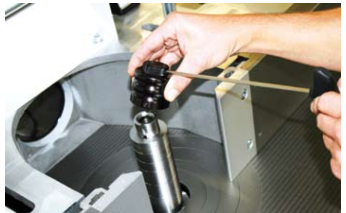
Komfortabler Werkzeugwechsel durch Fräser-Schnellspaneinrichtung
