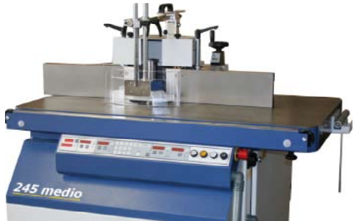
Große Tischplatte, mit nach links versetzer Spindel, schafft eine große Auflagefläche
