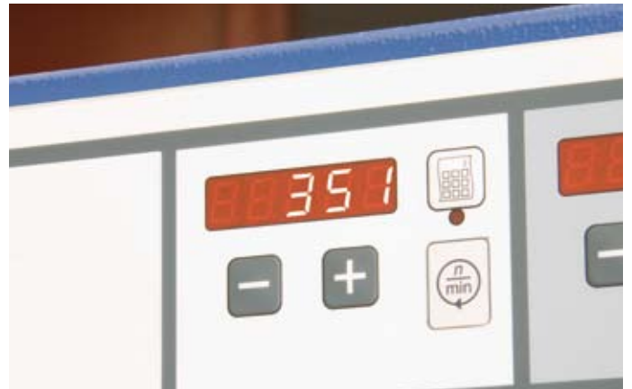
stufenlose Drehzahlverstellung 1500 - 10000 u/min
