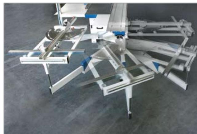
**Wegschwenkvorrichtung für Querschlitten**
